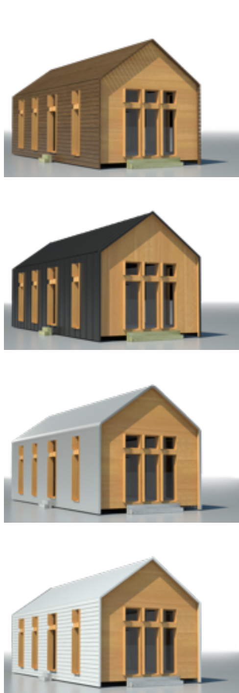
A gauche : variantes de la maison avec diverses enveloppes, de haut en bas : bois, zinc, plateaux métalliques à ondes verticales, plateaux métalliques à lames horizontales A droite : les différentes phases du chantier ont mobilisé Jean-Michel et Iohann sur l'équivalent de 22 semaines à raison de 8 heures par jour.
